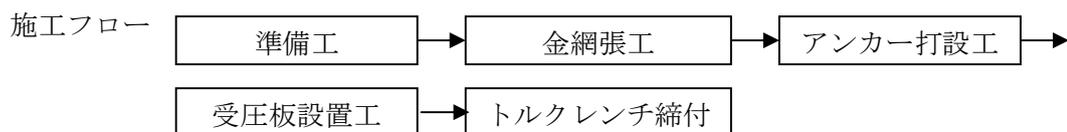
準備工 : 崩壊した法面を整形する。
