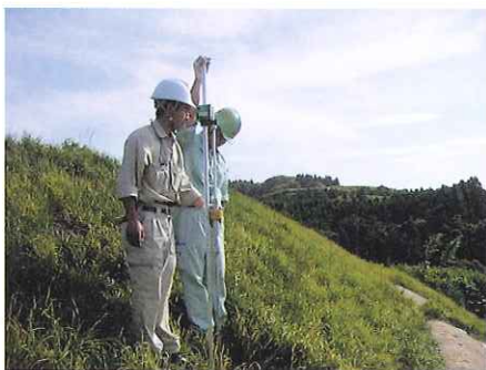
写真-1 SH貫入試験
