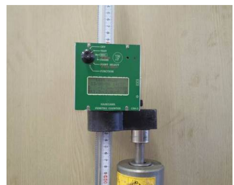
写真-3 SH 型貫入試験の貫入量自動記録装置
