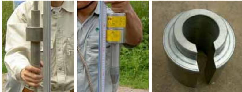
図 4-3 重錘(左:3kg、中:5kg、右:2kg(着脱式))
