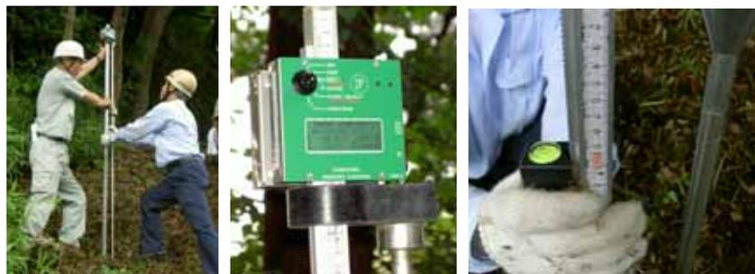
図 4-2 SH 型貫入試験機の設置(左:設置状況、中:データロガー取付状況、右:鉛直確認)
