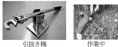
写真 2.2 ロッド引抜き機
