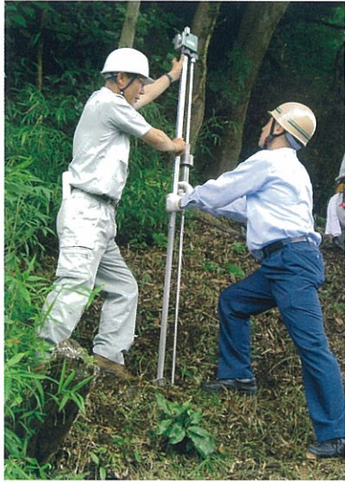
写真6-3 貫入試験実施状況 (写真提供：表土層調査技術研究会)
